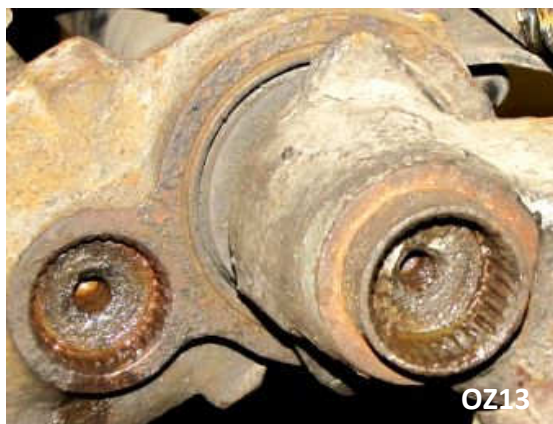
Bild 02 – Drehstabverzahnung (beachten Sie den Stabilisatorstab links – noch viel schlimmer; hoffentlich muss ich den nicht eines Tages wechseln)
