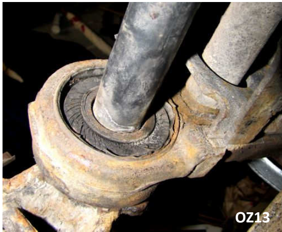
Bild 01 – alte linksseitige Buchse (Fahrerseite in D und A)
